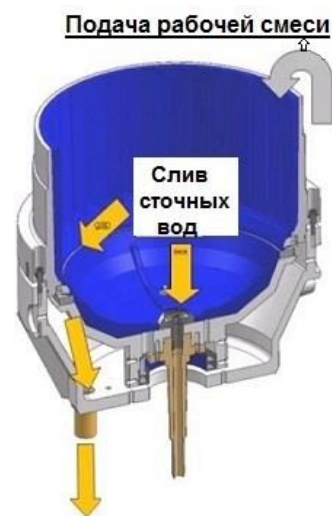
Контейнер с зазором 0,4 мм
